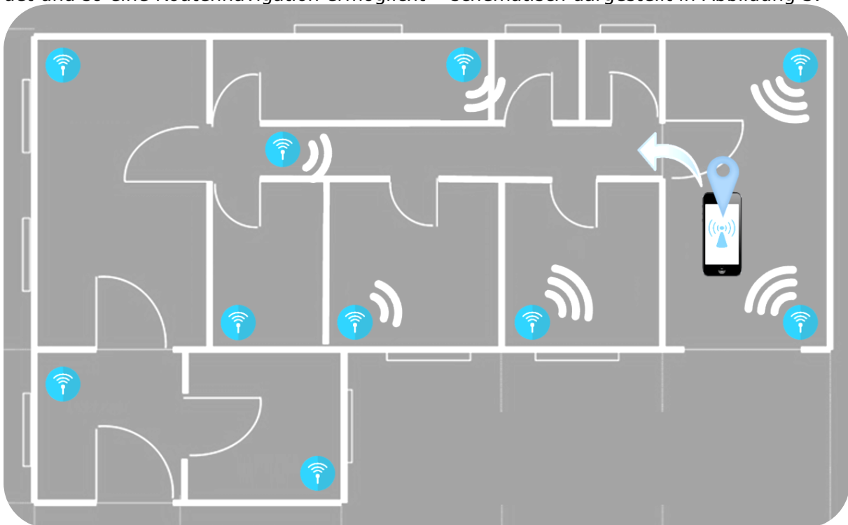
Abbildung 3: Schematische Darstellung zur Navigation mit Beacons (Blau) und Endgerät (Hier Smartphone) in Innenräumen mithilfe von WLAN oder Bluetooth Signalen
