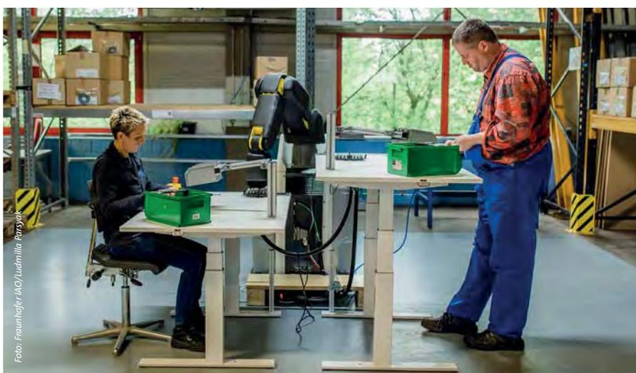
Der Roboterarm passt sich unterschiedlichen Tischhöhen an
