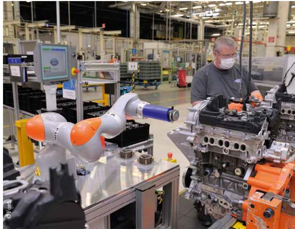
Die zwei schwerbehinderten Mitarbeiter, die derzeit im Wechsel an diesem Arbeitsplatz tätig sind, arbeiten eng mit dem kollaborierenden Roboter zusammen. Der Cobot, wie kollaborierende Robotersysteme auch genannt werden, ist direkt neben ihnen aktiv. Bei der Beobachtung der Arbeitsabläufe konnte erkannt werden, dass Mensch und Cobot nicht zeitgleich im gemeinsamen Bewegungsraum agieren müssen. Die Abfolge der Zusammenarbeit ist klar und eindeutig definiert und trainiert.
