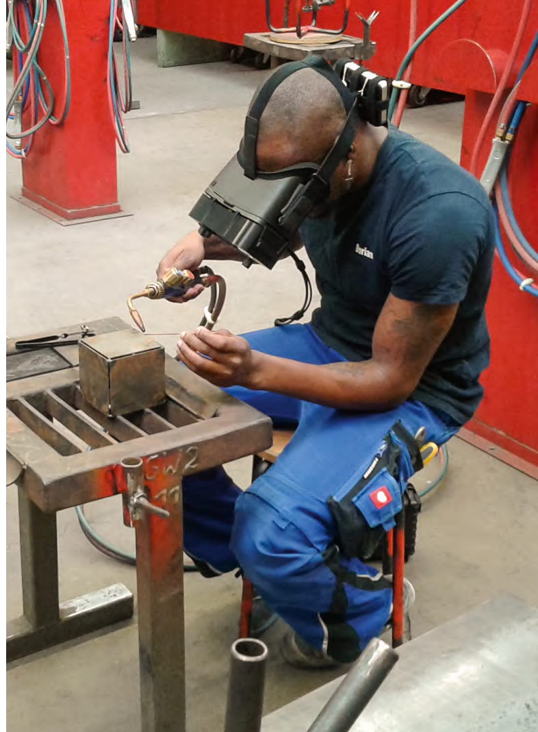
Erste Schweißversuche mit der VR-Brille.
