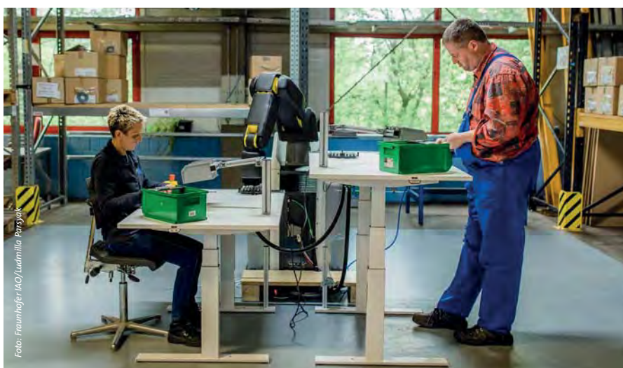
Der Roboterarm passt sich unterschiedlichen Tischhöhen an
