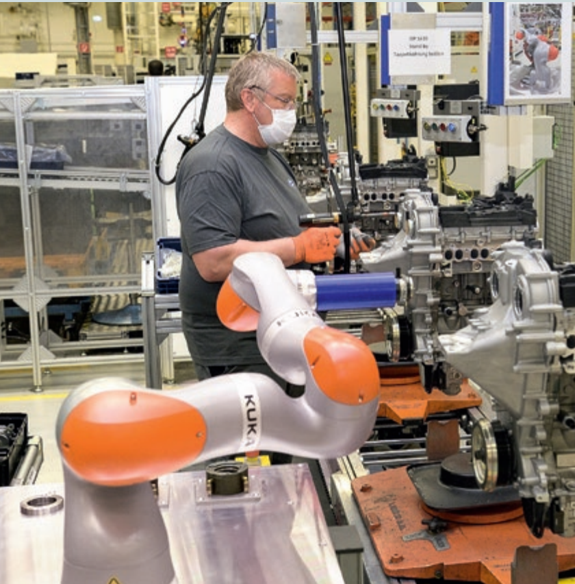
Der Roboter drückt Module in den Motor, die Brauner anschließend verschraubt. Foto: Rupert Oberhäuser/LVR
