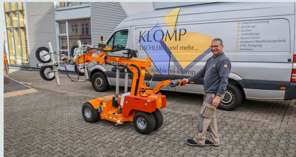
Der Lifter kann mit einem Haken versehen werden, so dass auch "herkömmliche" Lasten damit gehoben werden können. | © Rupert Oberhäuser
